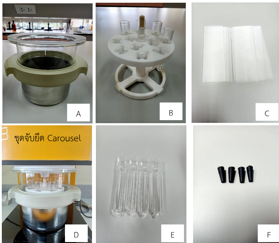
ภาพที่ ๑๓ อุปกรณ์สำหรับประกอบกับ Beaker สำหรับใส่ตัวอย่างในการวิเคราะห์ (Glass Container)
