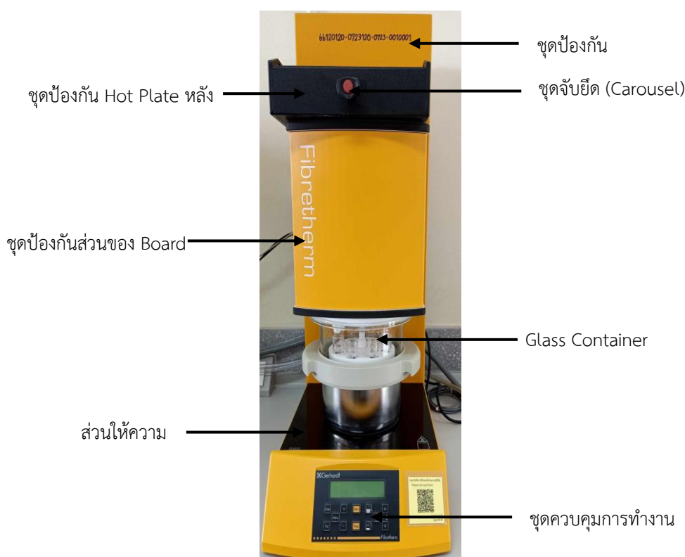
ภาพที่ ๑๒ โครงสร้างด้านหน้าเครื่องวิเคราะห์ปริมาณเยื่อใย Fibretherm FT 12
